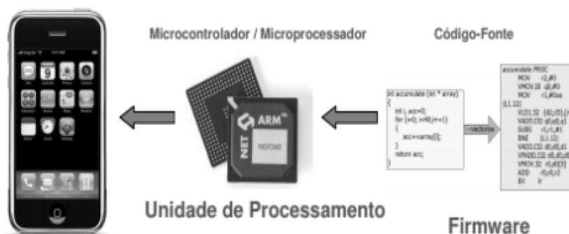
Figura 2 – Funcionamento de um sistema embarcado
